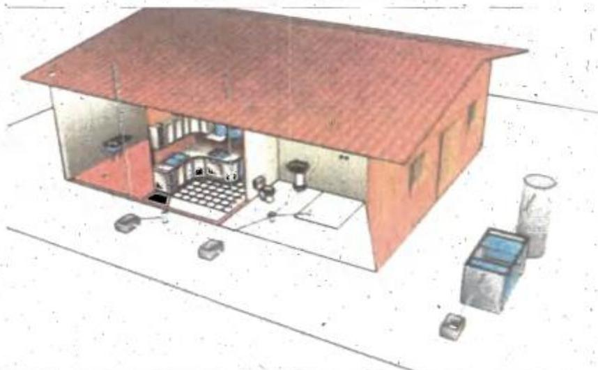
Capacidade para até 06 (seis) pessoas por Unidade Sanitária Individual (USI), com volume mínimo nominal de 1.990 Litros para fossa séptica, conforme a NBR 7229/93. Para o filtro anaeróbio de fluxo ascendente, um volume mínimo do leito filtrante de 1.000 Litros, de acordo com a NBR 13969/97.
